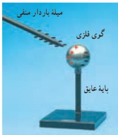
شکل ۱- ۳۰ نزدیک کردن میله باردار منفی به گوی فلزی خنثایی که روی پایه عایقی قرار گرفته است، موجب ایجاد بارهای القایی مثبت و منفی در دو طرف گوی فلزی می‌شود.
