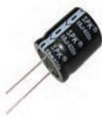
شکل ۱-۴۶ تصویری از یک خازن که روی آن ظرفیت و اختلاف پتانسیل بیشینه قابل تحمل نوشته شده است.
