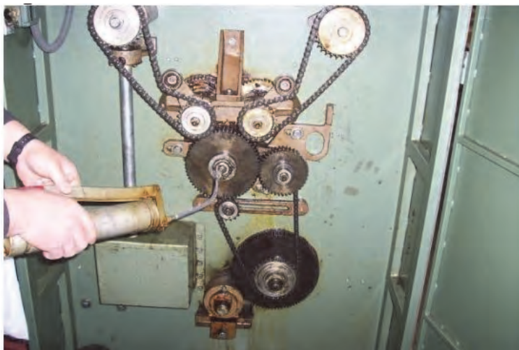
شکل ۱۷ روغن کاری و گریس کاری زنجیرها
