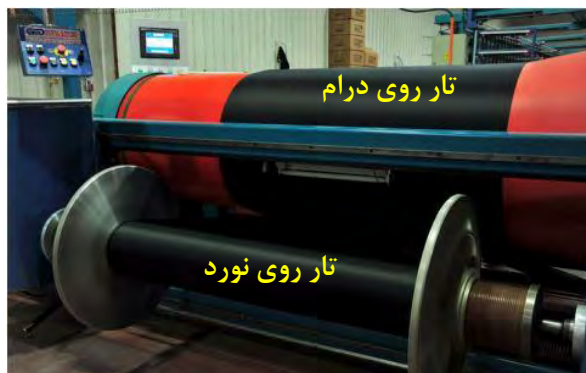
شکل ۱۶ برگردان چله روی نورد اصلی (انتقال نخهای تار از روی درام به نورد اصلی نخ تار)
