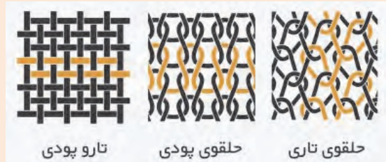
شکل ۵ مقایسه سه ساختار بافت تاری-پودی، حلقوی پودی و حلقوی تاری
