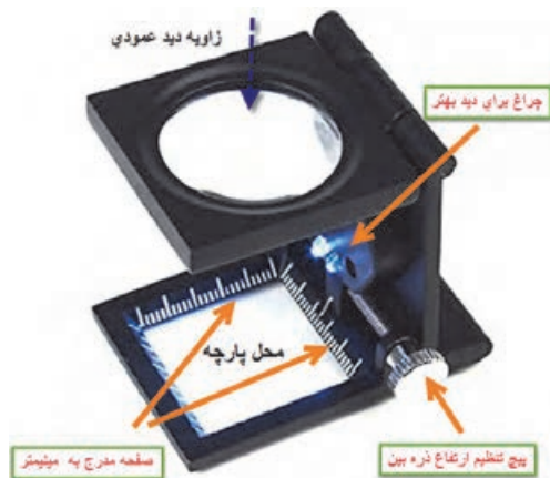
شکل ۱۶ نحوه استفاده از پود شمار
