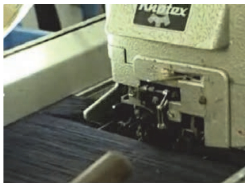
شکل ۳۱ دستگاه گره زن تار چله قدیم به تار چله جدید
