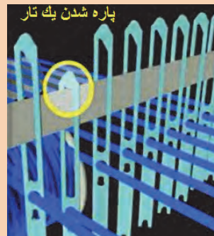
شکل ۳۵ نحوه توقف ماشین در اثر پارگی یک تار
