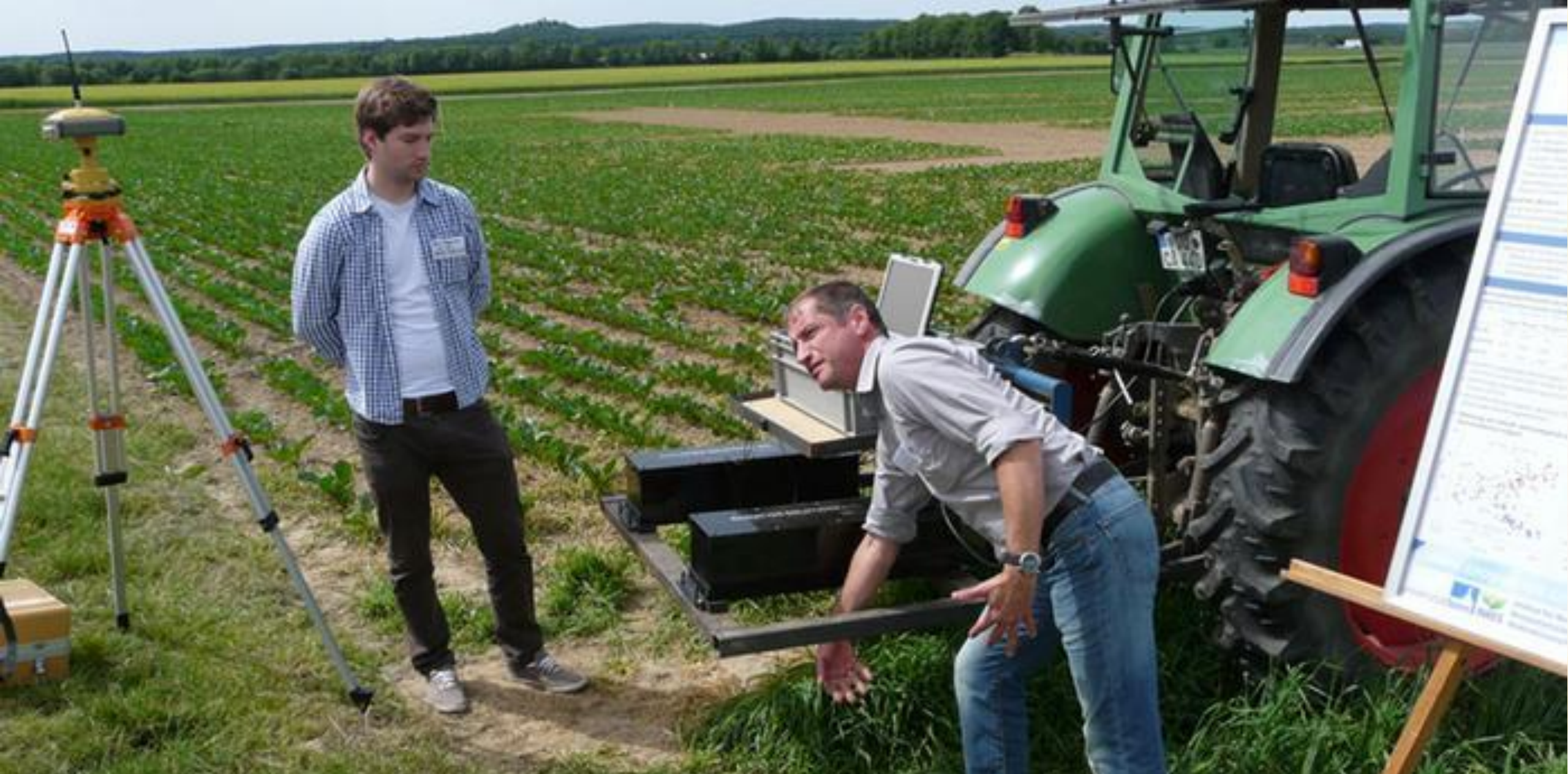
ماشین تشخیص جنس خاک، میزان کود و رطوبت در قسمت های مختلف زمین که بر میزان رشد گیاه و وزن محصول در قسمت های مختلف زمین اثر می گذارد. ( آلمان )
